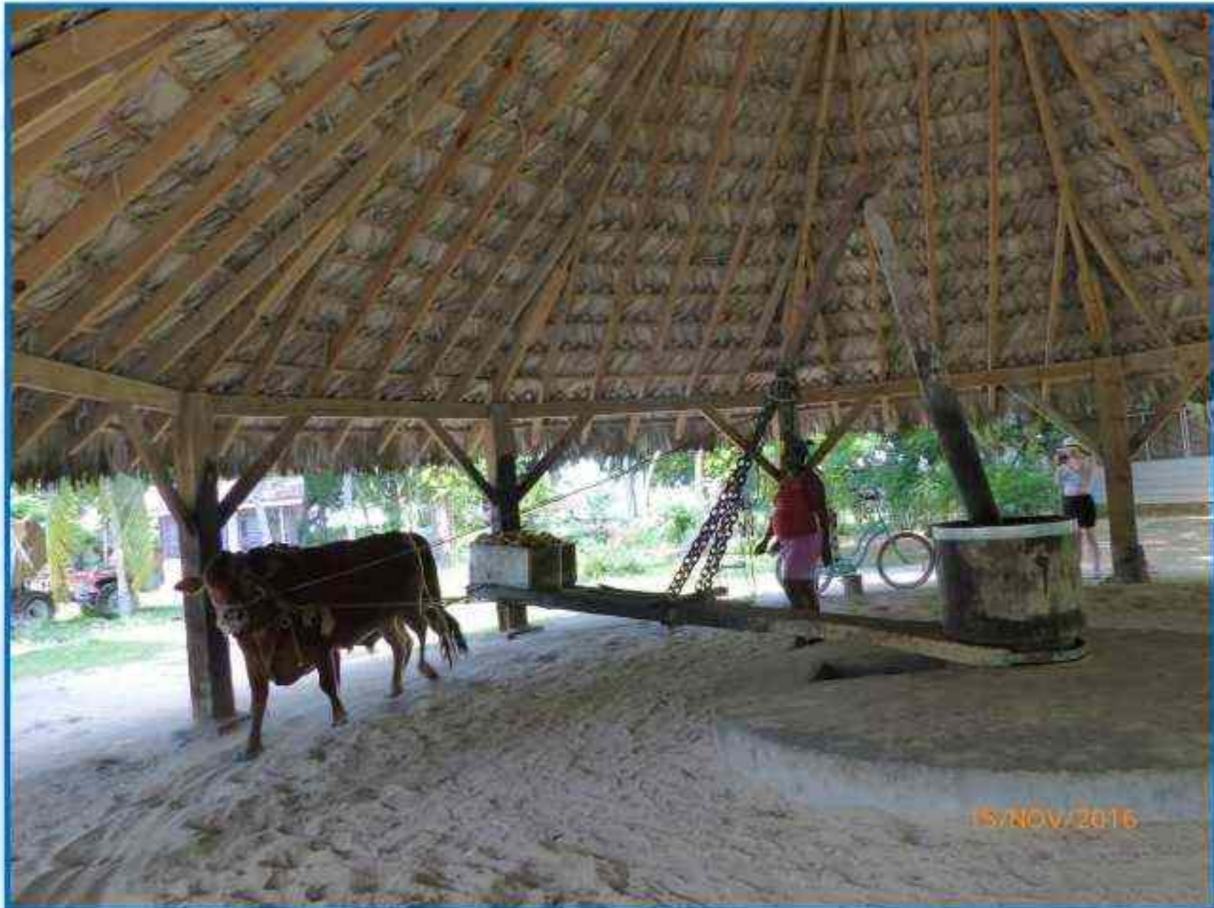
Moulin à sang (animal ou être humain). Utilisation d'un bœuf pour l'écrasement de noix de coco aux Iles Seychelles
