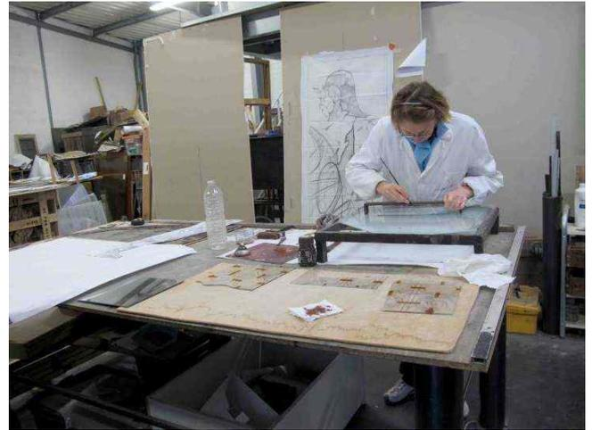
Les verres sont sertis dans des baguettes de plomb, assemblés pour former un seul réseau. Une soudure à l'étain est appliquée aux intersections des plombs.
