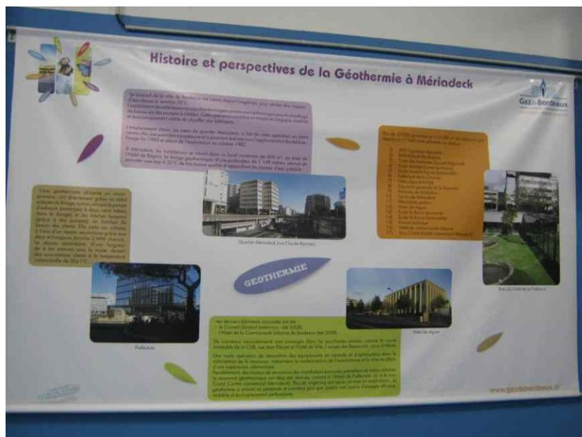
Un forage à 1148 mètres de profondeur permet de capter l'eau chaude d'une vaste nappe souterraine qui s'étend de Bordeaux jusqu'à Jonzac en Charentes et de la faire remonter grâce à une pompe immergée à 200 mètres sous terre avec un débit artésien de 30 m<sup>3</sup> par heure. En hiver, ce pompage permet de remplir trois grands réservoirs de stockage. Cette eau qui sort à environ 52 ° passe
