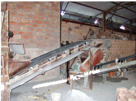
L'argile est placée dans des bacs et montée par une succession de tapis roulants pour être mélangée.
