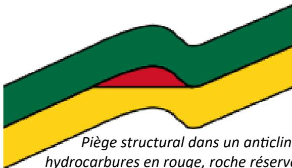
*Piège structural dans un anticlinal, hydrocarbures en rouge, roche réservoir en jaune, roche couverture en vert*
