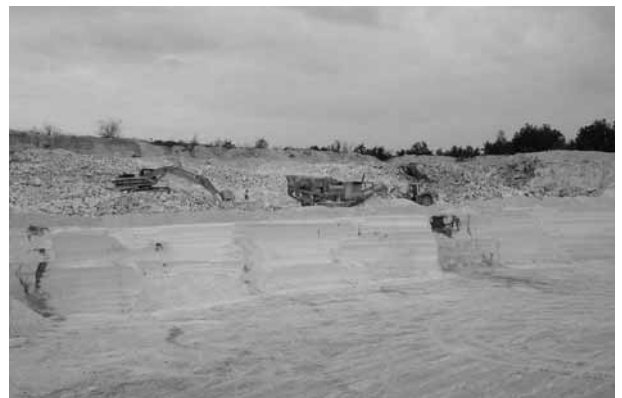
Photo 3. Les deux gradins d'extraction de carbonate, celui du haut abattu et celui du bas découpé à la haveuse (cliché Gérard Sustrac).
